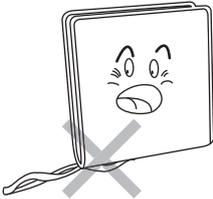
**Cihazın ağırlığını kontrol valfine ya da su tesisat borularına vermeyiniz!**
