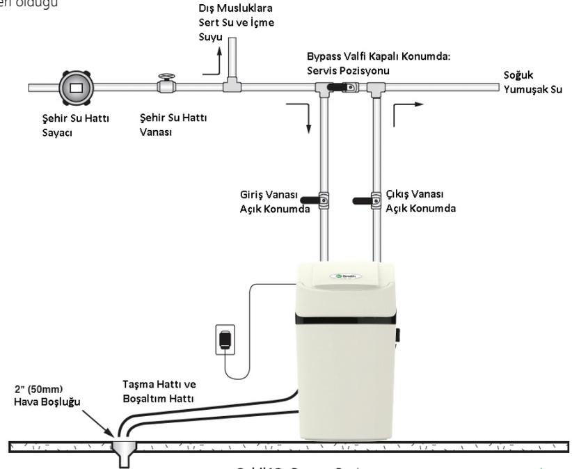
Şekil 12: Bypass Pozisyonu
