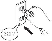
Cihaz üzerinde belirtilen güç kaynağı değerinden yüksek değerli güç kaynağı kullanmayın. Sadece 220-240V AC, 230V AC güç kullanın veya 24V AC adaptör kullanılmalıdır!
