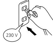
Cihaz üzerinde belirtilen güç kaynağı değerinden daha yüksek değerli güç kaynağı kullanmayın. Sadece 230V AC güç kullanın!
